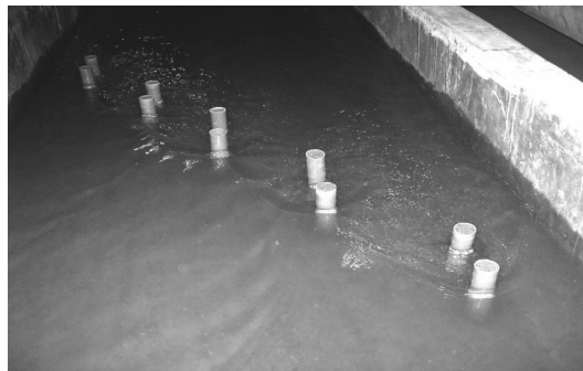
图10 桥轴与水流方向成 30^\circ 的表层水流现象
