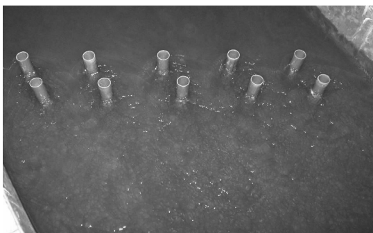
图9 桥轴与水流方向成 60^\circ 的表层水流现象
