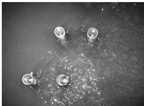
图8 串联双圆柱桥墩间的水流干扰现象
