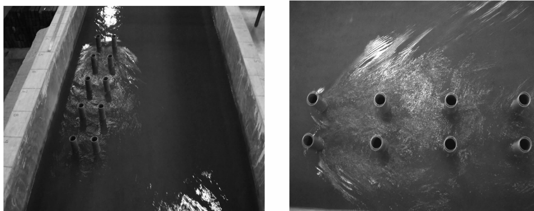
图11 桥轴与水流方向成 0^\circ 的表层水流现象
