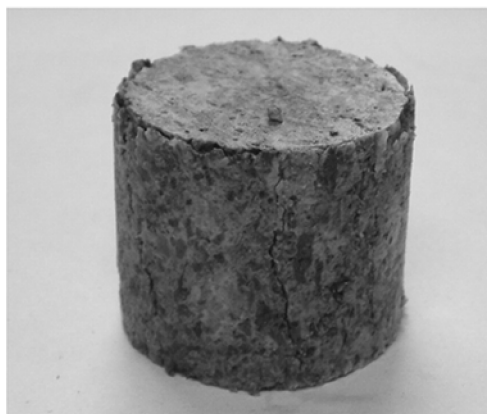
(a) 田下凝灰岩 (压密中最大轴向荷载: 8.3 kN)
