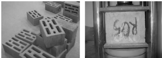
图 3 240 再生混凝土砌块抗压试验
