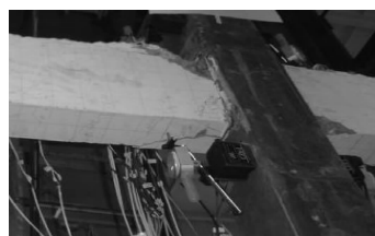
图7 试件JD-T2破坏状况
