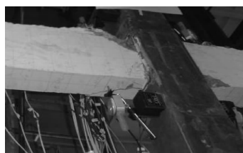
图6 试件JD-T1破坏状况
