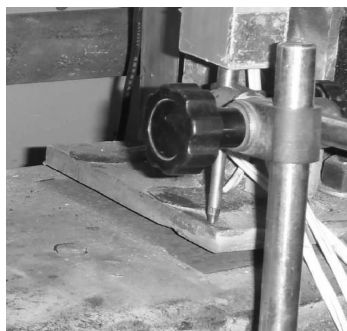
图 5 上弦杆件端板翘起 Fig. 5 The lift of upper chord end plate
