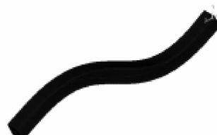
图4 预应力混凝土梁的二阶振型
