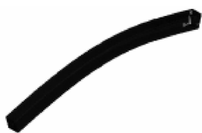
图3 预应力混凝土梁的一阶振型
