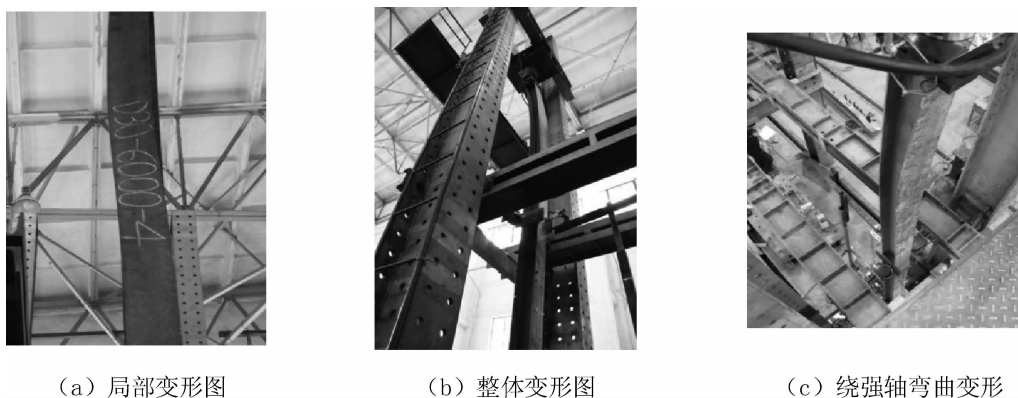
图 5 试件典型变形图
