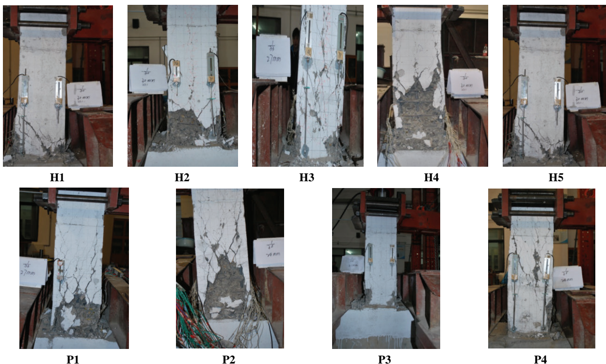
图4 试件破坏形态
