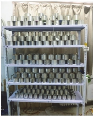
图 2 用于放置相变材料的架子
