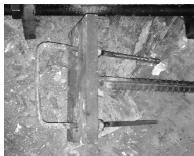
(b) 钢筋拔出破坏
