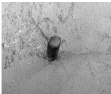
(a) 钢筋拉断破坏
