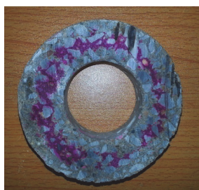
图 1 试件碳化程度测试
