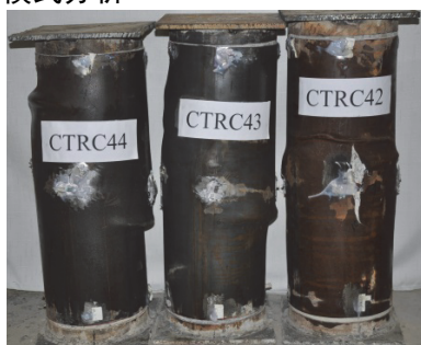
图4 试件破坏模式
