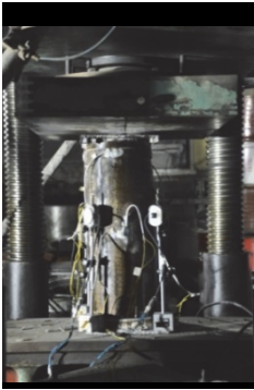
图 2 加载装置
