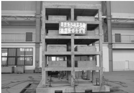
图 6 基础滑移隔震试验缩尺模型 Fig.6 The scale model on test of the sliding base isolation
