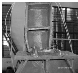
图 3 耗能段断裂
