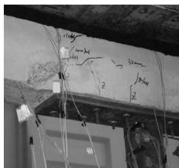
图 1 混凝土脱落
