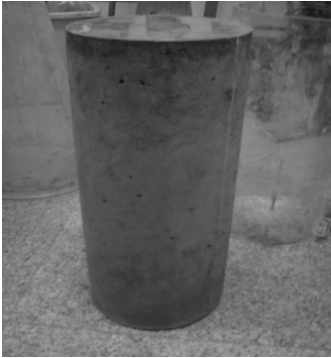
图 4 制备的基础模型 Fig.4 Prepared model of column foundation
