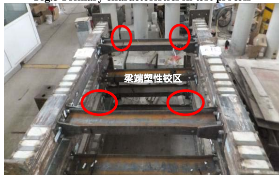
图4 试件最终破坏塑性机构
