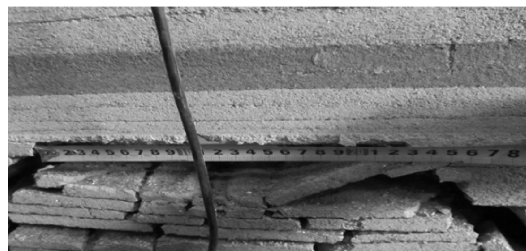
图6 4#煤层顶板塌陷形成的悬顶距离
