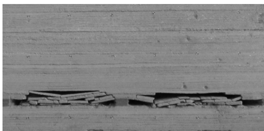
图4 工作面初次来压破坏
