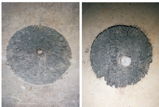
图 4 先装拔出法的破坏形态
