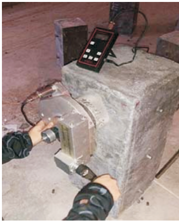
图 3 先装拔出试验
