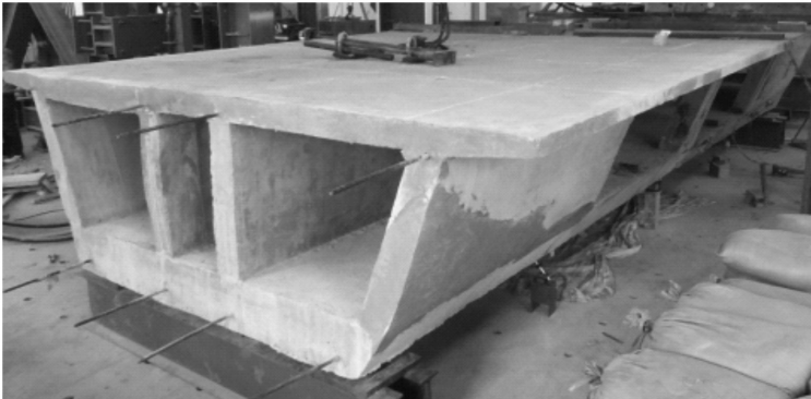
图 2 钢筋混凝土箱梁模型(1 : 6) Fig. 2 RC box-girder model (1 : 6)
