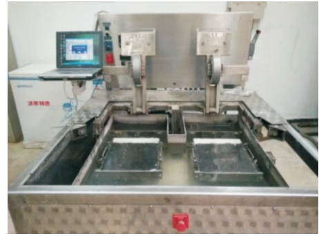
图10 汉堡车辙试验图像
