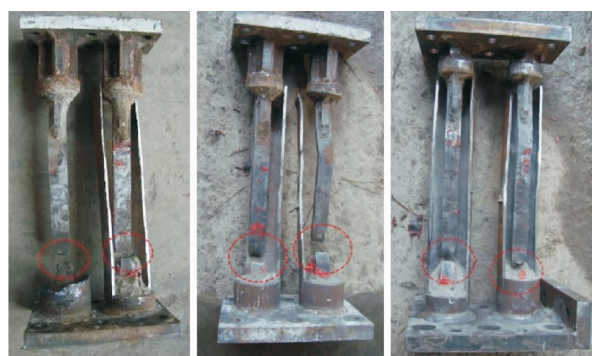
图13 可更换墙脚耗能构件 [38]
