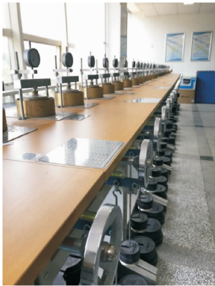
图 3 室内湿陷系数测定试验 Fig. 3 Collapsibility test
