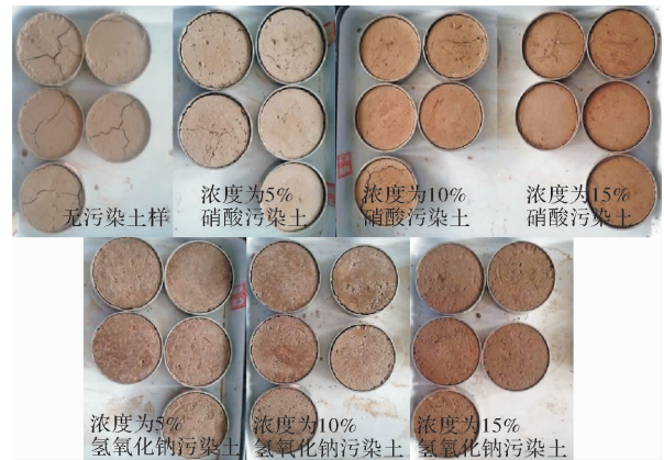
图6 室内湿陷性系数试验后土样烘干表面
