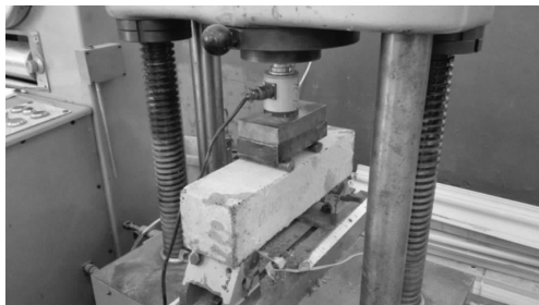
图 1 抗折试验装置
