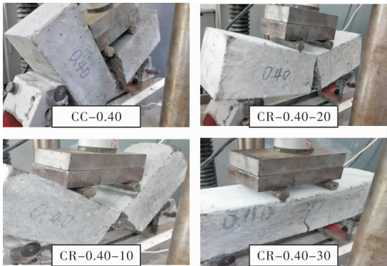
图 2 试件抗折破坏状态
