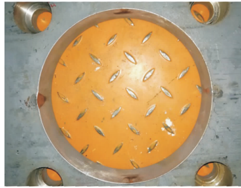
图4 中空连接钢板损伤(Q235B)
