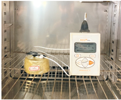
图3 导热系数测试过程
