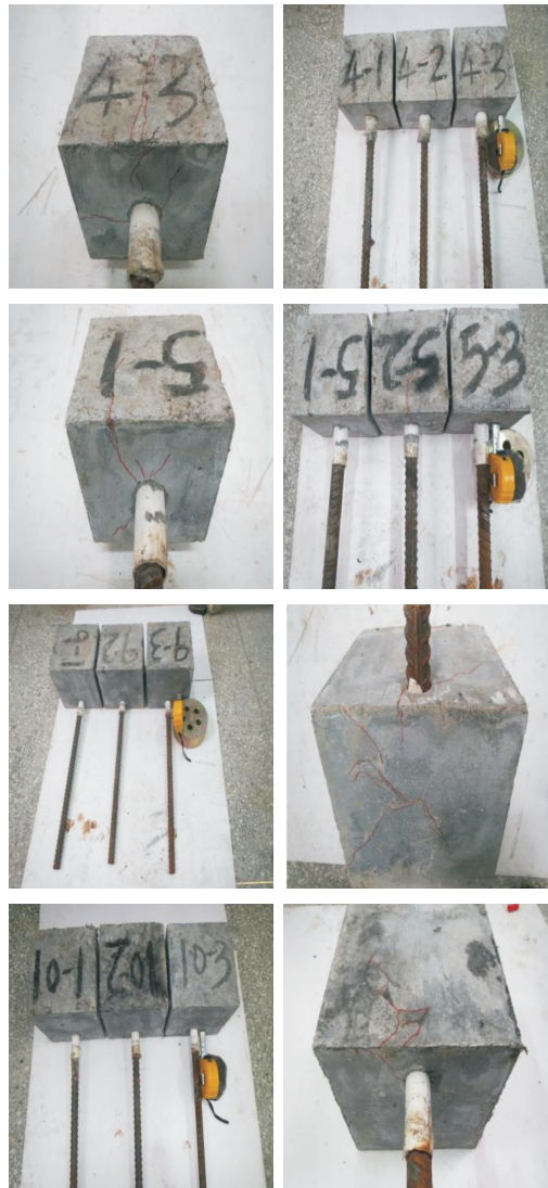
图 3 劈裂+拔出破坏试件
