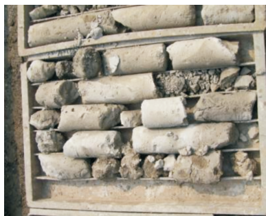
图 11 钻孔取芯结果
