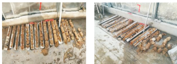
图7 现场钻孔取芯情况
