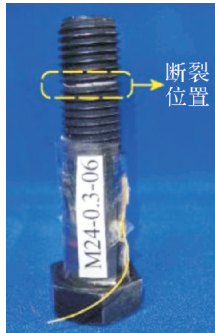
图 5 第二种疲劳断裂形态
