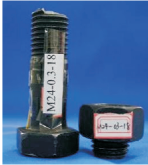
图 4 第一种疲劳断裂形态
