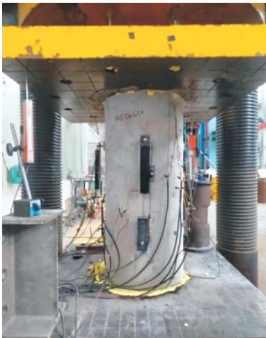
图 3 加载装置图 Fig. 3 Test set-up
