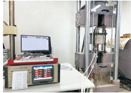
图5 拉拔测试
