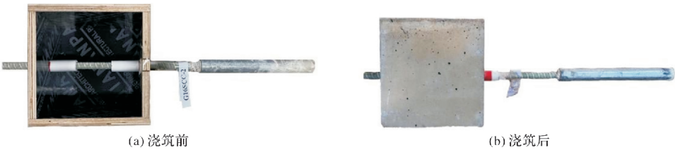
图 4 拉拔试件浇筑
