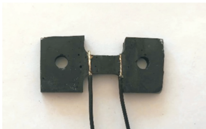
(c) 加工好并焊接电极的力电测试试件
