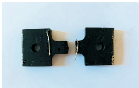
图 11 力电试件断裂照片
