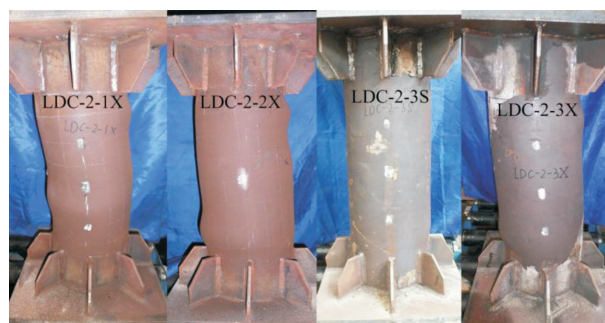
图5 试件破坏形态
