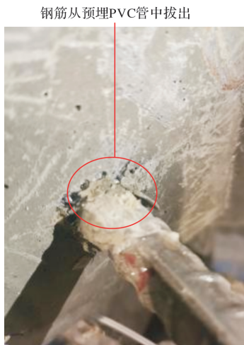
图 7 拔出破坏试件
