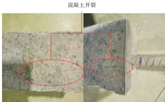
图 6 劈裂破坏试件
