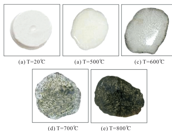
图 6 高温前后磷铝酸盐相变材料圆柱体试件的形状变化 (注:块状试件呈黑色由盛放试件的金属托盘高温变色所致,非磷铝酸盐相变材料自身颜色)
