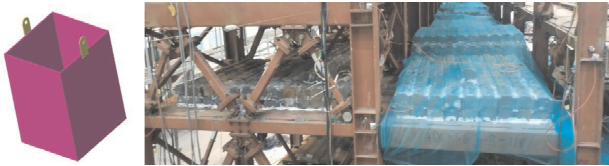
图 7 振动台储仓模型与振动台配重
