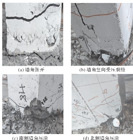
图3 PSW2 破坏图
