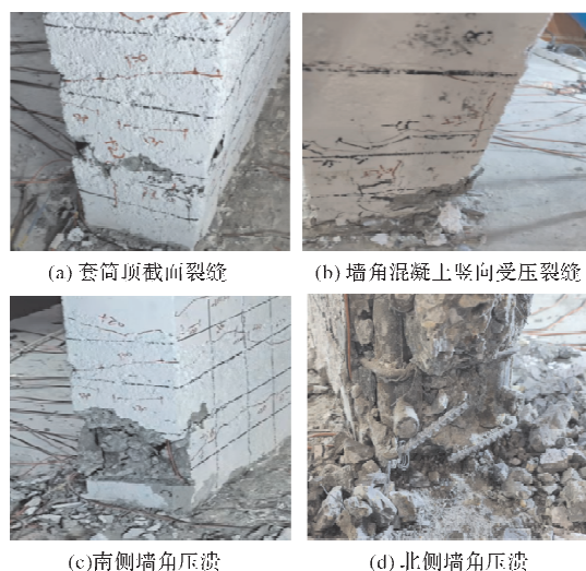
图2 试件 PSW1 破坏图
