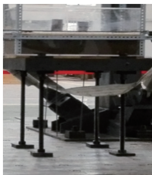
图2 振台试验装置图
