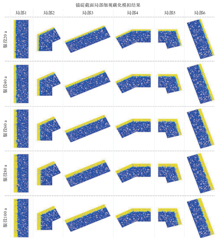
图 5 锚碇结构长期服役碳化作用映射结果
