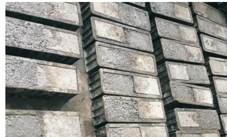
图 2 浇筑陶粒混凝土后试件照片
