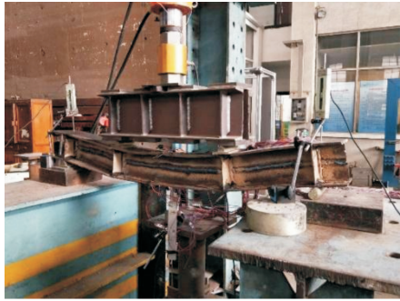
图 3 预应力张拉装置 Fig. 3 Tension device of prestress
