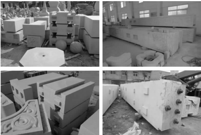
图 6 榫卯构件 Fig. 6 The mortise-tenon component
