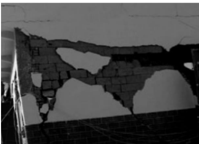
图 22 墙体的斜向裂缝 Fig. 22 Inclined crack
