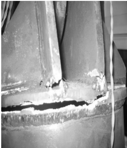
图 7 试件 SP2 的局部破坏 Fig. 7 Local failure of SP2
