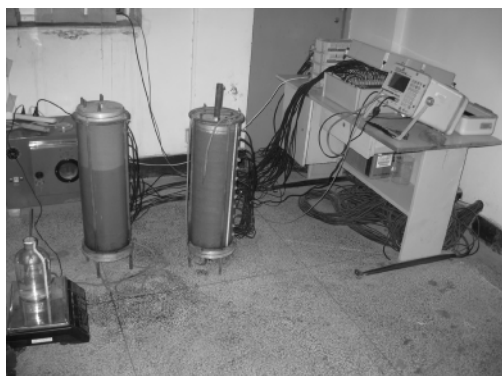
图 2 等温条件下土体水分迁移测试系统实体图
