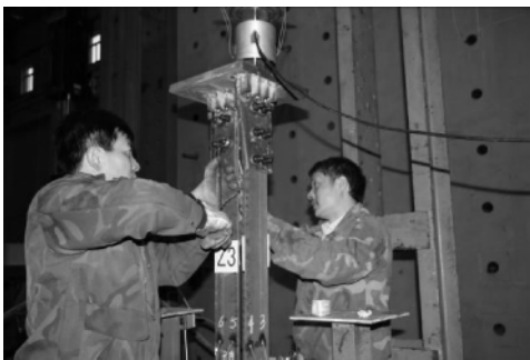
图 3 二次加载紧固连接螺栓
