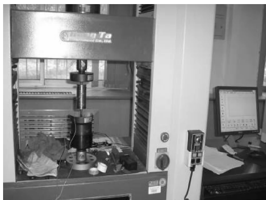
图 8 GMM 作动器输出力性能测试试验
