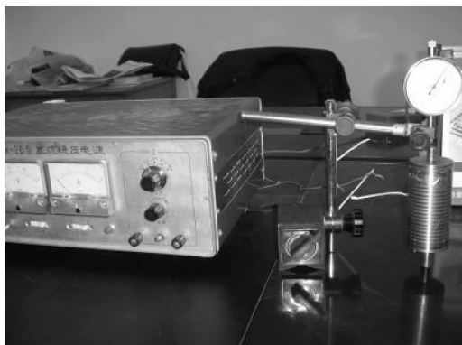
图 11 GMM 作动器输出位移性能测试试验
