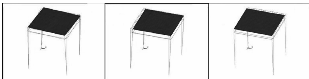
图5 模型结构前3阶振型图
