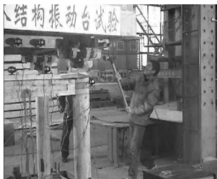
图3 激振锤人工敲击试验
