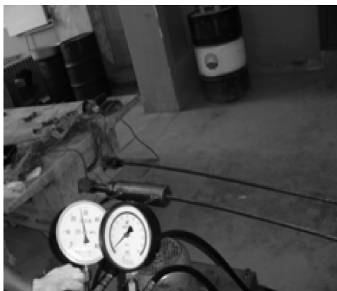
图 7 模型试验梁预应力筋张拉 Fig. 7 Prestress tensioning for test girder
