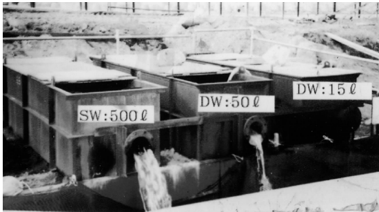
图 3 SWP 工法与 DW 工法的扬水量对照
