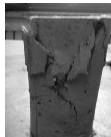
图4 圆柱体试件破坏形态图
